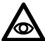
Vor dem Anhängen an den Kran unbedingt Sichtprüfung, dass der Winkel im Bereich der Anschlagpunkte unbeschädigt ist und dass das eingelagerte Material nicht herausfallen kann, gegebenenfalls die Klappe schliessen.
