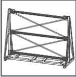
Vertikalrahmen unter Zuhilfenahme der Führungsdorne in die vorgesehene Aufnahme stellen und mit den Schrauben M24-170 verschrauben
