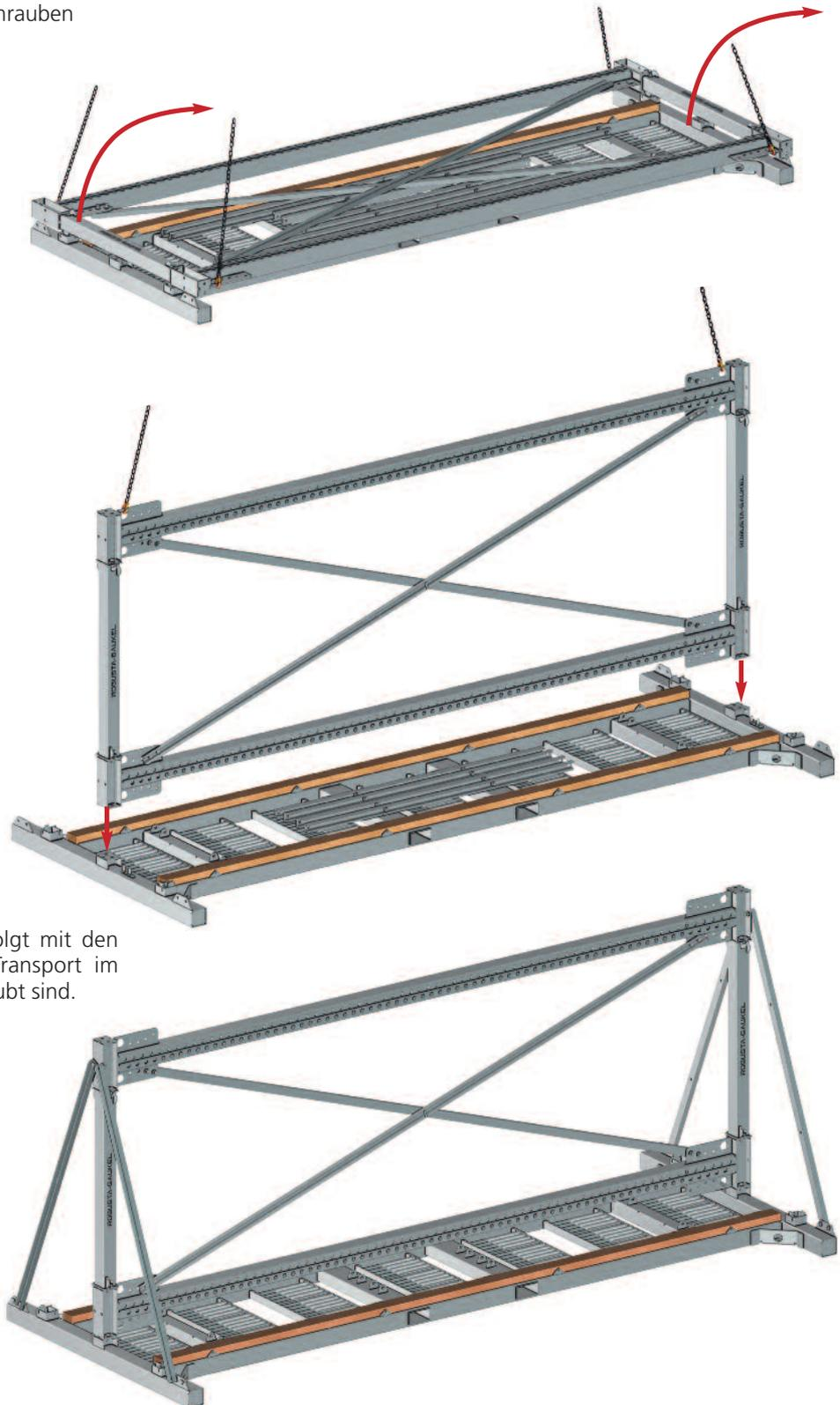
Die seitliche Stabilisierung erfolgt mit den 4 Querstreben, die für den Transport im Bodenrahmen sicher angeschraubt sind.
