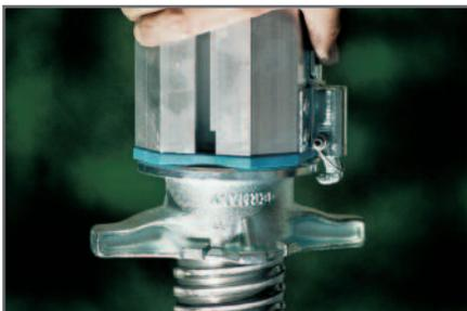
Durch das Einstecken einer zweiten Spindel in der Kopfplatte wird der **Verstellbereich** von 1,20 m **verdoppelt** auf 2,40 m.
