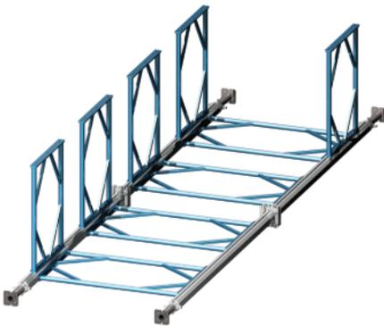
Da keine Teile in die Höhe getragen werden müssen, werden immer wieder Montagezeiten von ca. 0,22 Stunden/steigendem Meter für einen 4-stieligen Turm erreicht.
