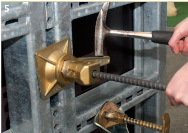
5 Einfaches Vorspannen des Ankerstabes mit Hammer durch großen Hebelarm des Ringschlüssels.
