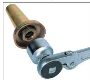
Nach ausreichender Erhärtung des Betons werden nach Abbau der Schalung die Konen mit Hilfe von **Freilaufschlüsseln mit Sechskantnuss** schonend ausgebaut.
