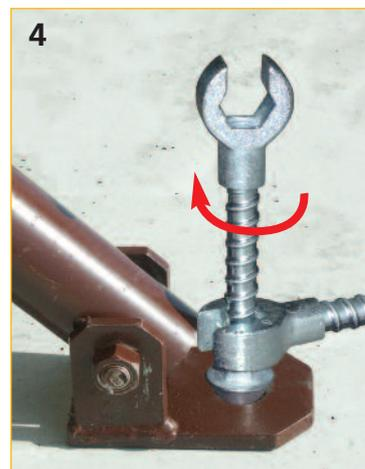
4. Endgültiges kraftschlüssiges Anziehen der Schraube durch einfaches Drehen mit einem zweiten Anschraubset. Durch die Schraubenschlüssel-form des Anschraubsets kann auch die kegelige Bundmutter fest angezogen werden.
