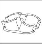
Unter der bestehenden Decke musste eine Stütze mit elliptischem Grundriss saniert werden. Zum Ein- und Ausschalen der mit Scharnieren verbundenen Schalungshälften waren seitliche Konsolen zum Transport mit dem Stapler angebracht. Als erstes wurde der aufgeständerte Schalungsboden am rechteckigen Stützenfuß angeklemt, danach wurde die Schalung aufgesetzt. Das Einpressen des Feinbetons erfolgte anschließend durch den Einpress-Stutzen an der Unterseite des Schalungsbodens.
