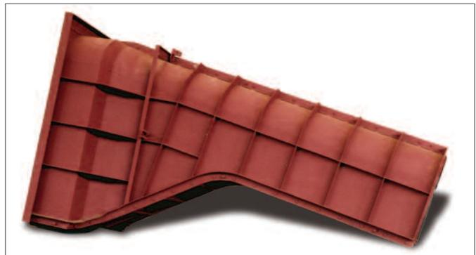
**Sonderschalung für Abluftkanal** im Kraftwerksbau. Die spezielle Geometrie des Stützenkopfes mit angenäherten doppelt gekrümmten Flächen musste aus aerodynamischen Gründen möglichst genau eingehalten werden.
