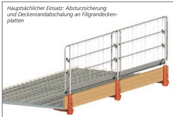
Hauptsächlicher Einsatz: Absturzsicherung und Deckenrandabschalung an Filigrandeckenplatten
