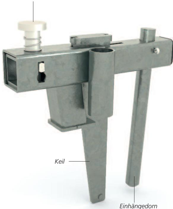
Da es keine auskragenden Teile gibt, können parallel Abdichtungs- und Erdarbeiten problemlos ausgeführt werden. An ihrem flexiblen Pin lässt sich die Hohlwandklemme für 6- und 8-cm dicke Schalen einstellen und blitzschnell lösen. Somit entfallen zeitraubendes Unterfüttern und eine überhängende Demontage der Hohlwandklemme im Gefahrenbereich.
