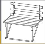
**VORTEIL 6: nach außen klappbare Seitenschutzpfosten, auch mit Verlängerung**
