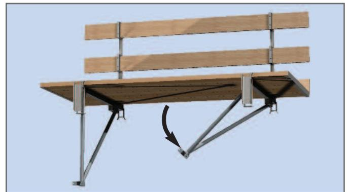
Die Unterbauten sind in sich starr und nur an zwei Gelenkpunkten befestigt. Dadurch wird eine sehr **große Stabilität** bei sehr **geringem Spiel** erreicht. Ein gefährliches Einknicken der Druckdiagonalen ist damit ausgeschlossen!
