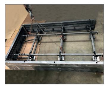
:Die Fertigung der schrumpfbaren Stahlrahmen
