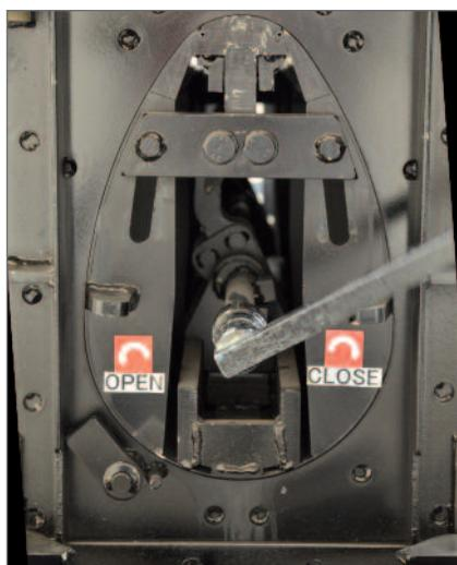
Öffnen der Exzentrerspindel mit Steckschlüssel
