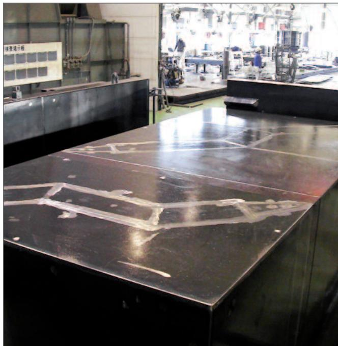
*Kombinierte Schrumpfmehchanik für großen Innenkern bei Überkopfbetonage, auch hier sind alle Schalflächen parallel zueinander.*
