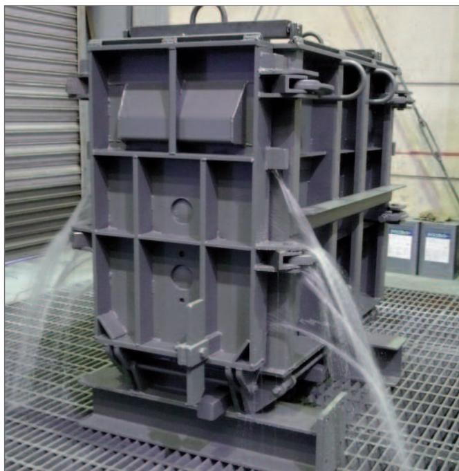
*Der Wassertest: Jede Stahlschalung wird nach ihrer Fertigstellung durch das Befüllen mit Wasser auf ihre Dichtigkeit überprüft. Anschließend wird das Wasser kontrolliert abgelassen.*
