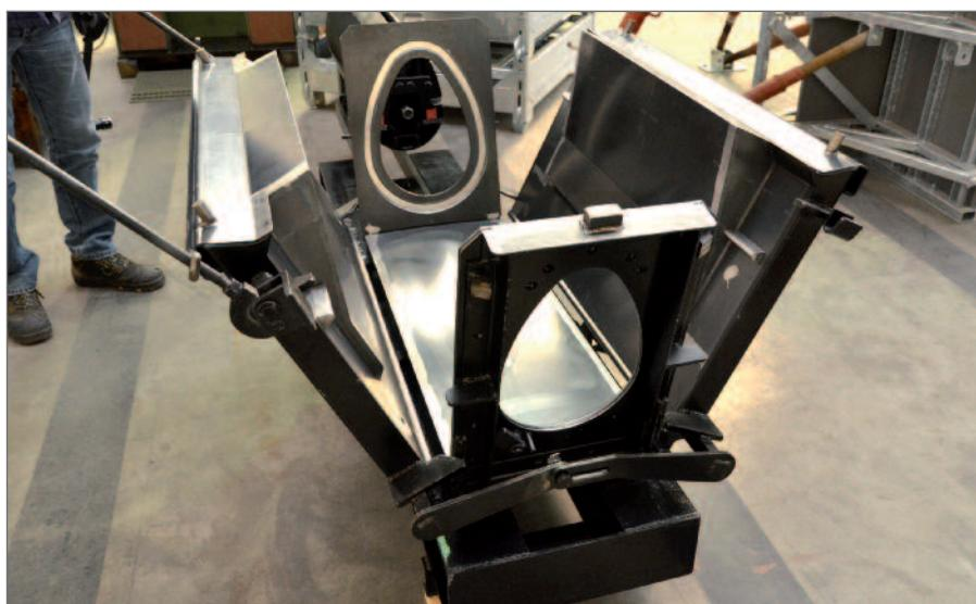
Bei Auf- und Zuklappen der Seitenelemente bewegen sich alle Elemente zwangsgeführt gleichzeitig. Die Rinne ist nun ausgeschalt und kann entnommen werden.
