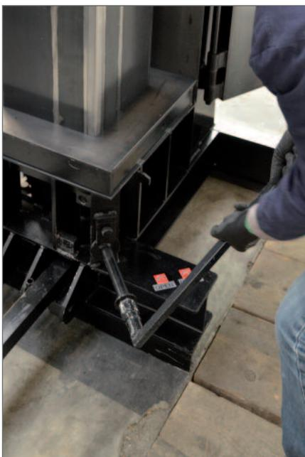
Öffnen der Exzentrerspindel mit Steckschlüssel
