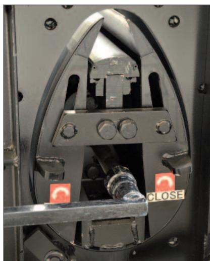
Zwangsgeführtes Schrumpfen des Innenkerns
