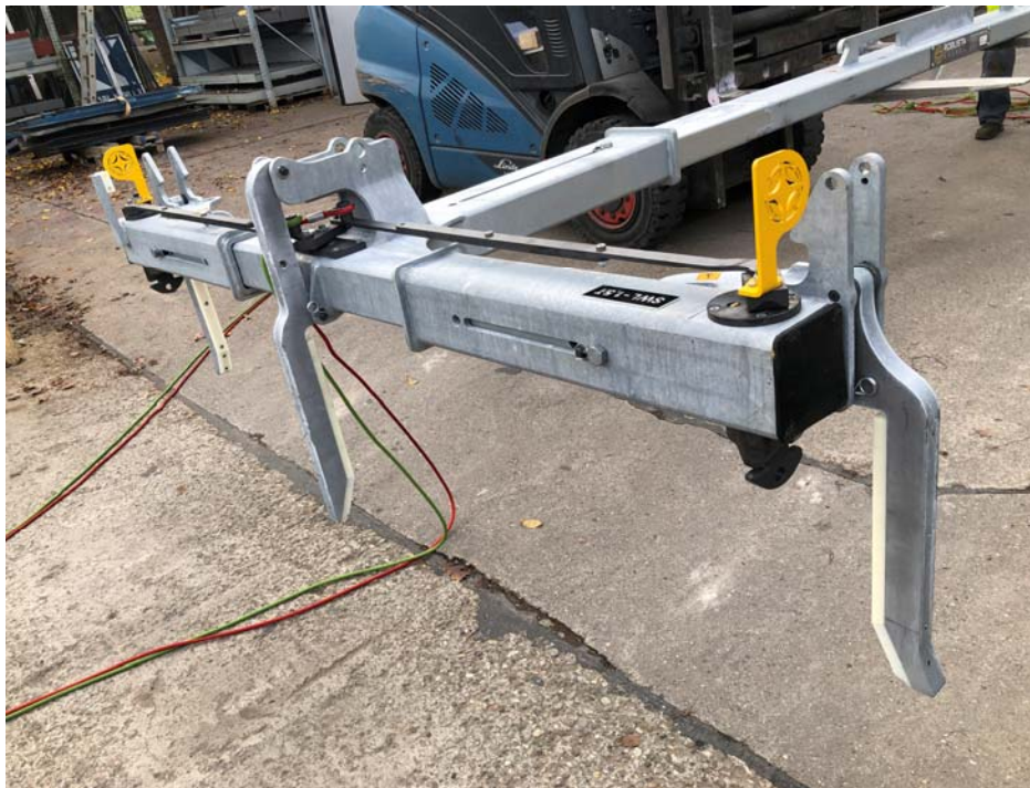
BU: ConFlex im Detail: Twist-Locks für sichere Verriegelung (Quelle: ROBUSTA-GAUKEl)
