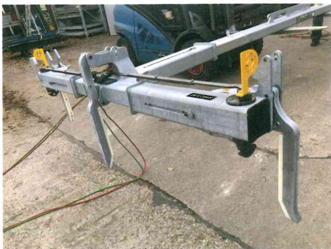
Bild 2 ConFlex im Detail: Twist-Locks für sichere Verriegelung.
