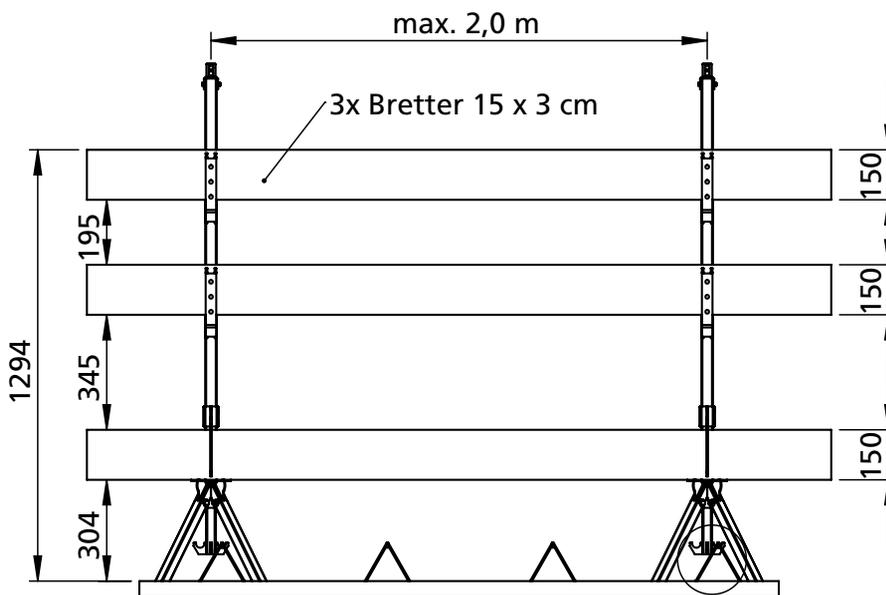
Bei Einsatz mit Gitterelementen ist keine Verringerung des Abstands bei Höhen ab 40 m erforderlich!
